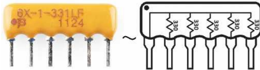
Niz od pet otpornika od 330\Omega , svi zajedno povezani na jednom kraju.
