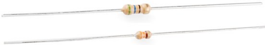
Otpornik od pola vata ( \frac{1}{2} W) (gore) veličine do četvrt vata ( \frac{1}{4} W).
